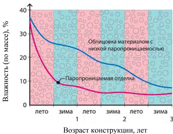
Рис. 8. Высыхание газобетона в однослойных конструкциях
